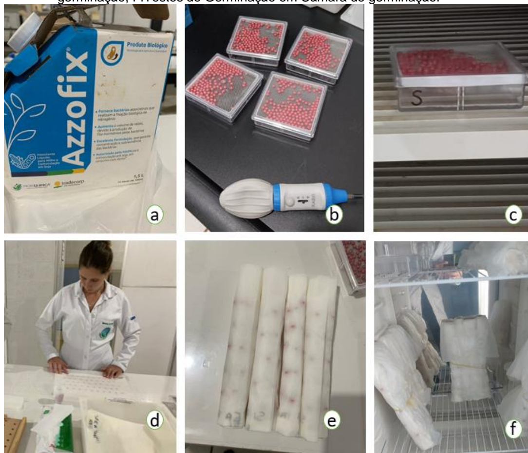
Figura 2: Etapas de montagem do experimento. A: Azzofix, B: Etapa de tratamento e montagem de teste de envelhecimento acelerado, C: Teste de envelhecimento acelerado, D: Montagem de teste de germinação, E: Rolinhos de papel do teste de germinação, F: Rolinhos de papel do teste de germinação, F: Testes de Germinação em Câmara de germinação.
