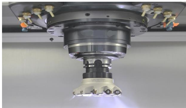
Figura 05. Aplicação típica de MQL.
