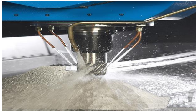
Figura 04. Aplicação típica de fluido de corte.
