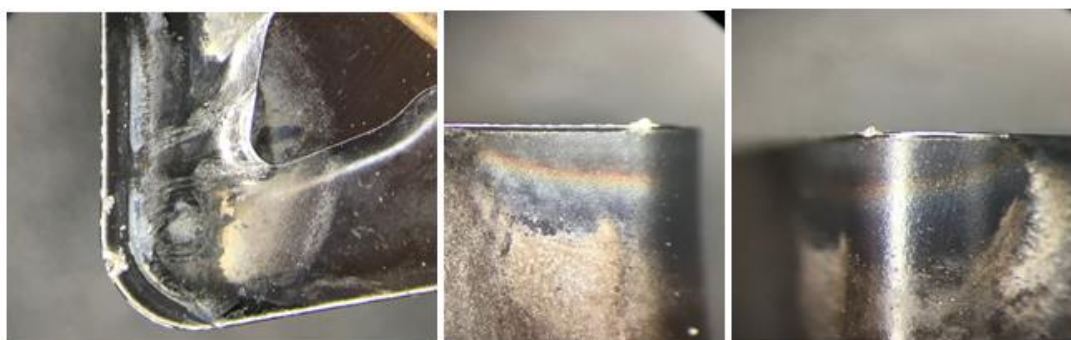
Figura 8 – Desgaste no inserto com revestimento de óxido de alumínio no torneamento do aço SAE1020.
