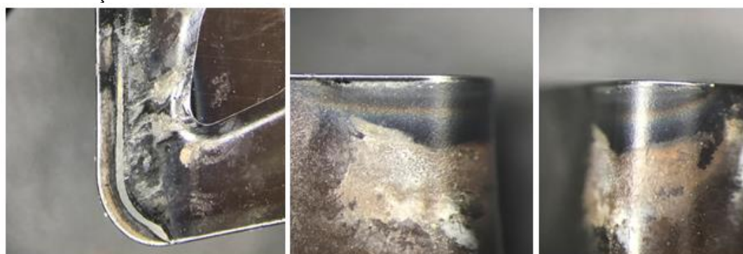
Figura 6 – Desgaste no inserto com revestimento de óxido de alumínio no torneamento do aço SAE1045
