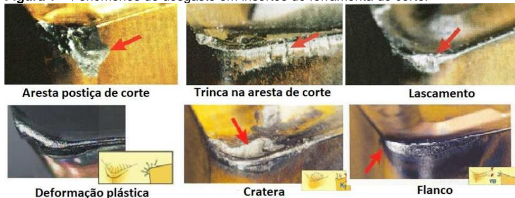
Figura 1 – Fenômenos de desgaste em insertos de ferramenta de corte.
