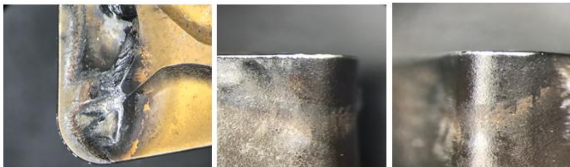
Figura 5 – Desgaste no inserto com revestimento de nitreto de titânio no torneamento do aço SAE1045
