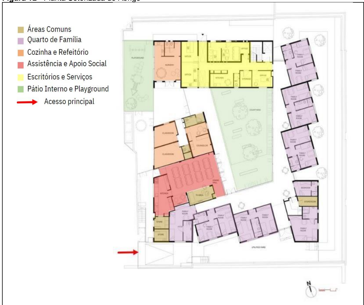
Figura 12 - Planta Setorizada do Abrigo
