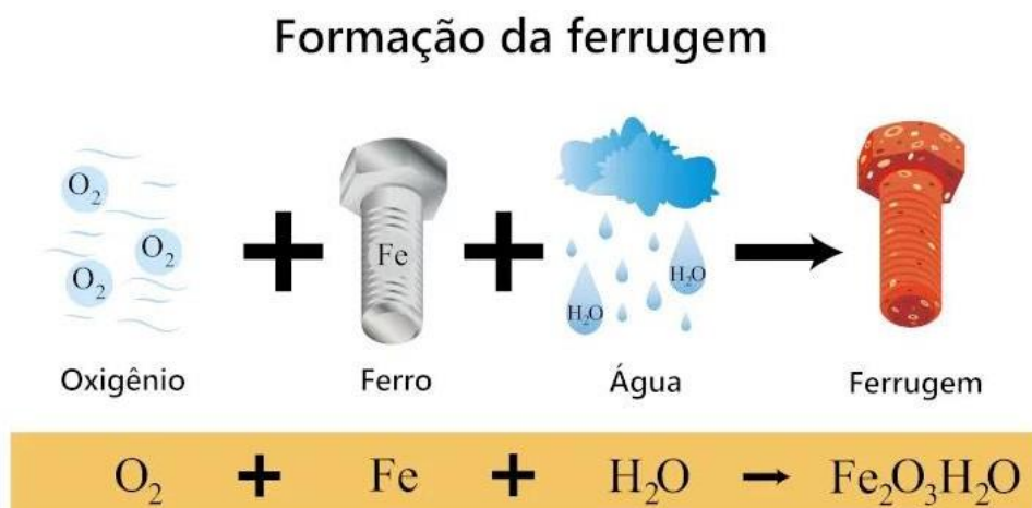
Figura 8 – Esquema de formação da ferrugem
