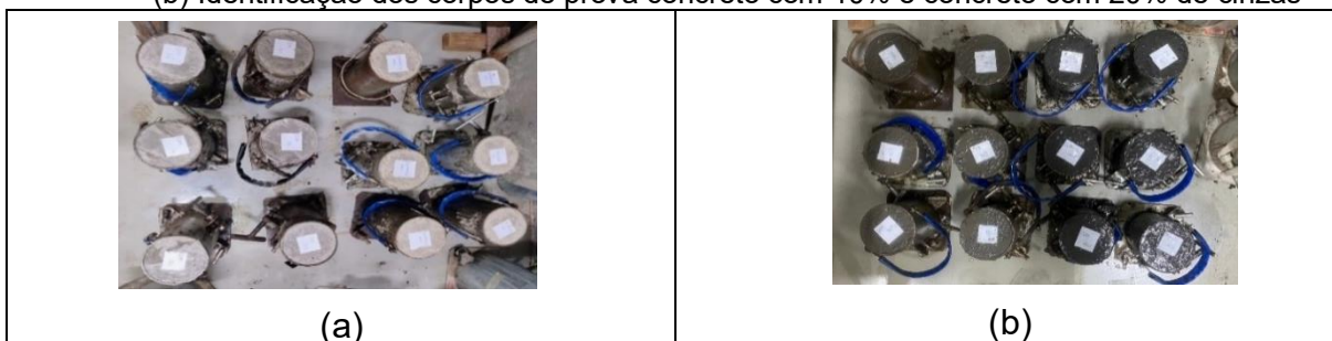
Figura 12 - (a) Identificação dos corpos de prova concreto convencional e concreto com 5% de cinza, (b) Identificação dos corpos de prova concreto com 10% e concreto com 20% de cinzas
