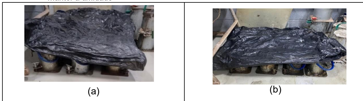
Figura 13 - (a) Cobrimento dos corpos de prova concreto convencional e 5% de cinzas para manter a umidade, (b) Cobrimento dos corpos de prova concreto com 10% e 20% de cinzas para manter a umidade
