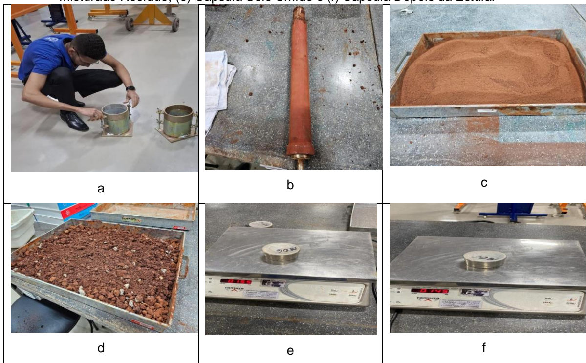
Figura 4 - (a) Montagem dos Cilindros, (b) Soquete Utilizado, (c) Solo Peneirado Utilizado (d) Solo Misturado Resíduo, (e) Capsula Solo Úmido e (f) Capsula Depois da Estufa.
