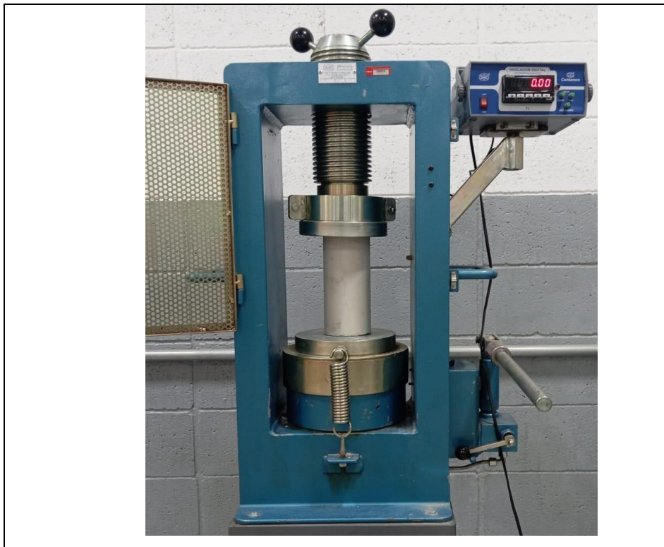
Figura 7: Ensaio de Compressão Simples.
